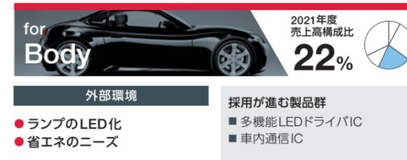
ロームは、省エネ性やデザイン性に優れた車載用LEDに関連した製品を幅広く提供しています。ハイビームでも先行車や対向車に光が当たらないように制御できるLEDドライバはその一例です。また、自動運転開始・終了のコミュニケーション・ライティング向けにターコイズブルーLED素子をいち早く実用化し、この色の国際規格化を促進しています。
