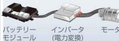
バッテリーモジュール    インバータ(電力変換)    モータ
