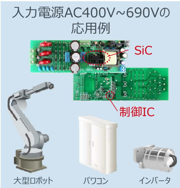
SiC (シリコンカーバイド) : シリコン (Si) と炭素 (C) で構成される化合物半導体。現在主に使用されているシリコンと比較して電力変換効率が高く、また高温でも安定して動作するという特徴を持っています。
